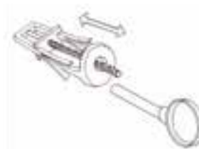
Teckning av mekanismen till skruvlås
