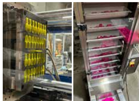
Moderna verktyg tar hand om tillverkningen av brickor Här matas brickorna upp
