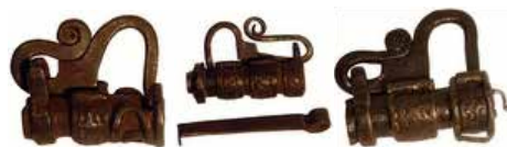
Rörformade hänglås med svängbygget och spärrfjädrar
